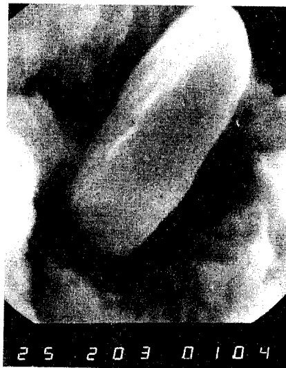
Slika 6 - SEM mikrofotografija čestice zdrobljene karbidne faze. x20 000 [41].
