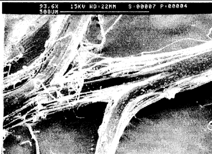
Slika 1 - Polipropilenski film nakon ispitivanja čvrstoće pri zatezanju Figure 1 - Polypropylene tape after testing of tensile strength
