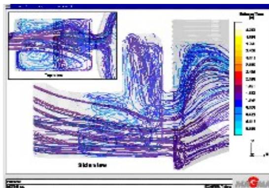
Slika 4. - Vektori brzine livenja sa skalom [1] Figure 4. – Velocity vectors for scale cast [1]
