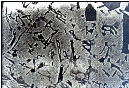
Slika 5. Mikrostruktura klipne legure, termički obrađeno stanje, x 500
