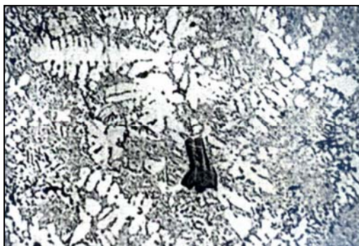
Slika 4. Mikrostruktura klipne legure, liveno stanje, x 100
