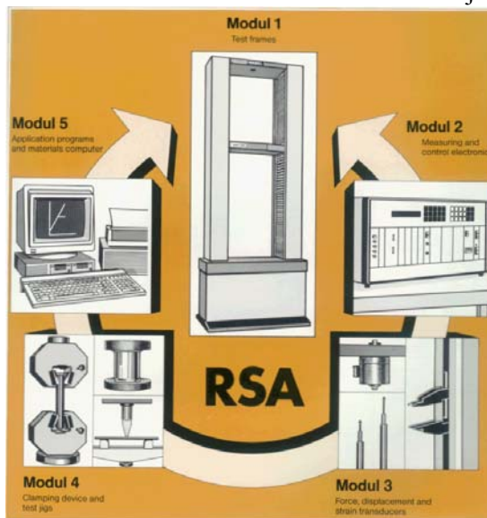
Slika 4 - Shema savremenog sistema za ispitivanje metala Figure 4 - Scheme of the modern metal materials testing system
